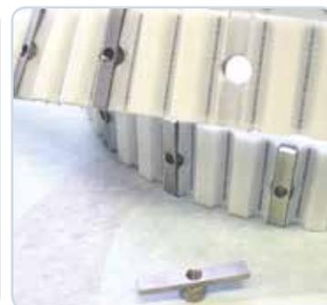
PU Zahnriemen als Meterware, Ausgangsmaterial für alle Förderriemen für unterschiedlichste Anwendungen. Die Zugträger bestehen im Standard aus Stahl, alternativ sind auch Aramid oder Edelstahl möglich.
