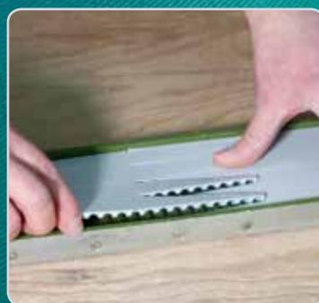
Riemen für die Fördertechnik werden aus Meterware in beliebiger Länge in speziellen Formen verschweißt. Endlos verschweißte Riemen liefern wir in der Regel innerhalb weniger Tage.
