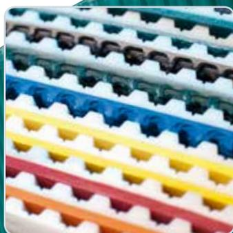
Wir beschichten und konfektionieren Zahnriemen und andere Riemen für unterschiedlichste Anwendungen. Durch Verwendung von spezielle Polyurethansorten können kundenspezifische Eigenschaften erzielt werden.
